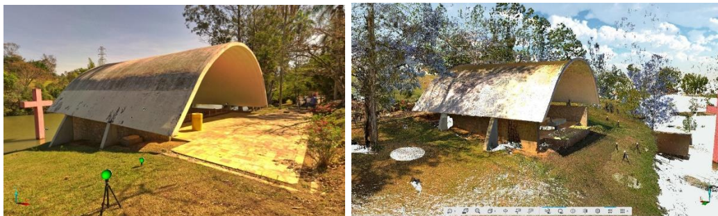
Figura 2 – Atividade A – À esquerda, a indicação manual das esferas de referência (em verde) para registro das cenas no software Faro Scene. À direita, a nuvem de pontos processada pelo software Faro Scene após registro das cenas capturadas.
