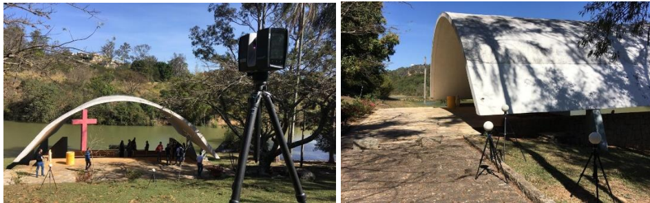
Figura 1 – Atividade A – À esquerda, escaneamento laser na Capela da Fazenda Veneza com escâner laser da Faro. À direita, esferas para referência do escaneamento e registro de cenas.
