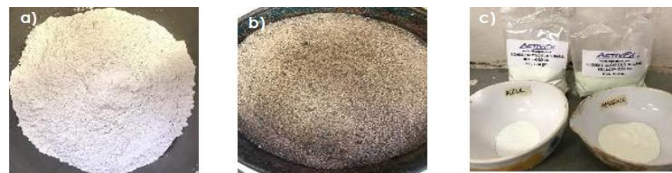
Figura 3 – Componentes da argamassa: a) cimento branco, b) areia e c) pigmentos
