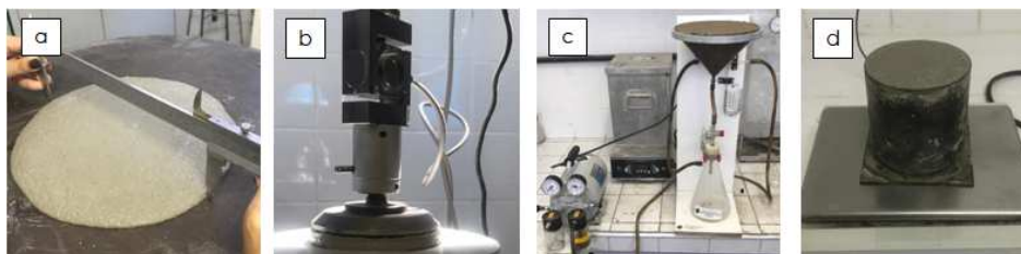
Figura 2 – Ensaios no estado fresco. (a) Índice de consistência; (b) Squeeze-flow ; (c) Retenção de água; (d) Densidade e teor de ar incorporado
