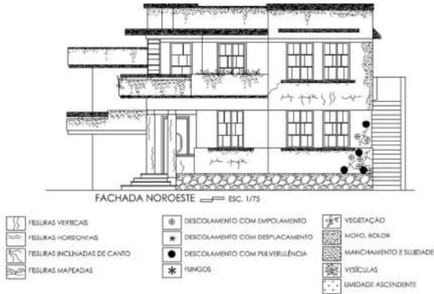
Figura 5: Levantamento gráfico das patologias encontradas na fachada noroeste
