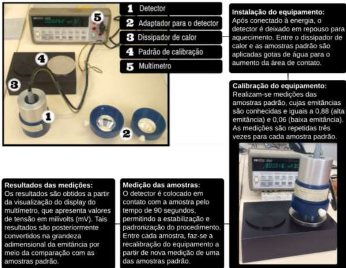
Figura 3 - Medição com emissômetro Devices and Services Company (D&S) , modelo AE1
