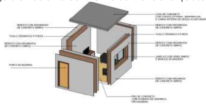
Figura 3 – Sistema construtivo convencional (Caso 01)
