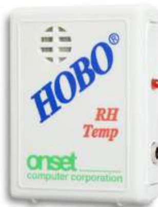
Figura 4 – Aparelho programável utilizado para a coleta dos dados de temperatura interna e externa do ar
