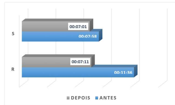
Gráfico 6 – Tempo dos operadores, por equipe, na execução da concretagem dos pilares.
