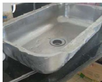
Figura 6 - Vista superior do descolamento da cuba
