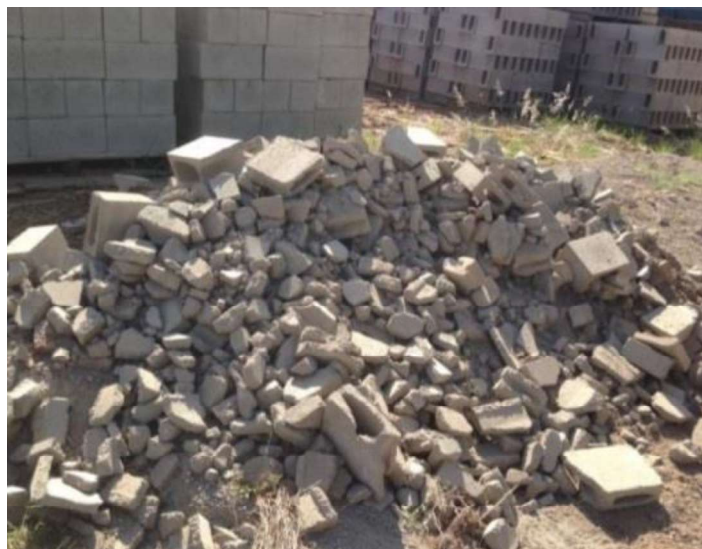
Figura 1 – Resíduos de Blocos de Concreto
