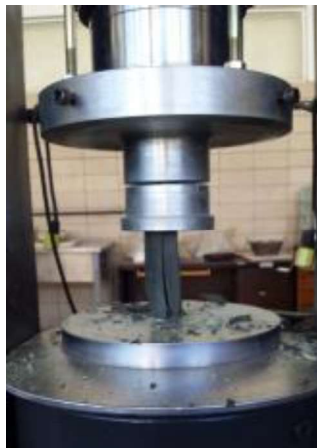
Figura 4 - Corpo de prova após ruptura
