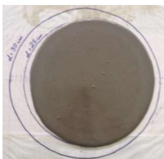
Figura 1: Ensaio de espalhamento em argamassas autonivelantes.
