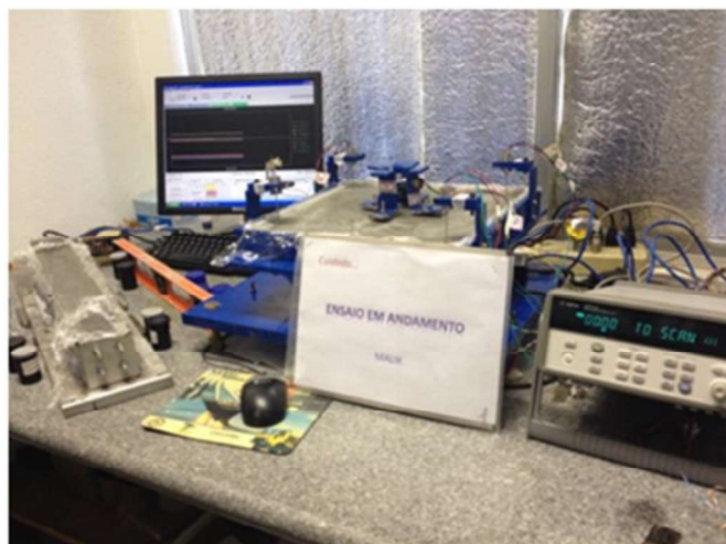
Figura 3: Ensaios de retração linear e empenamento " curling ".
