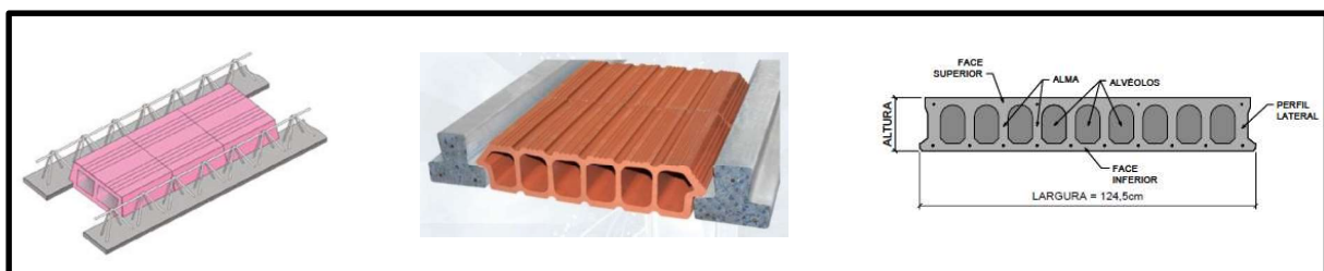
Figura 4 – Tipologia de Lajes para Alvenaria Estrutural
