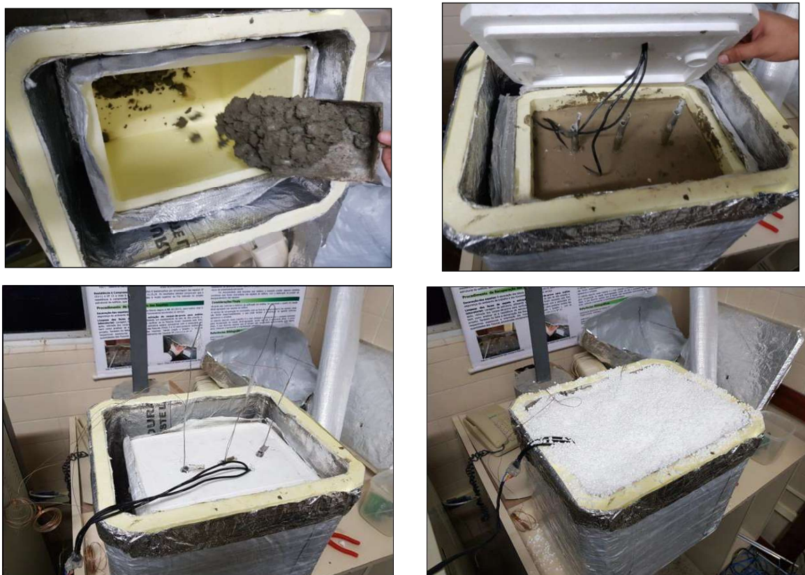
Figura 7 - Preparação e instrumentação do concreto no modelo reduzido em laboratório.
