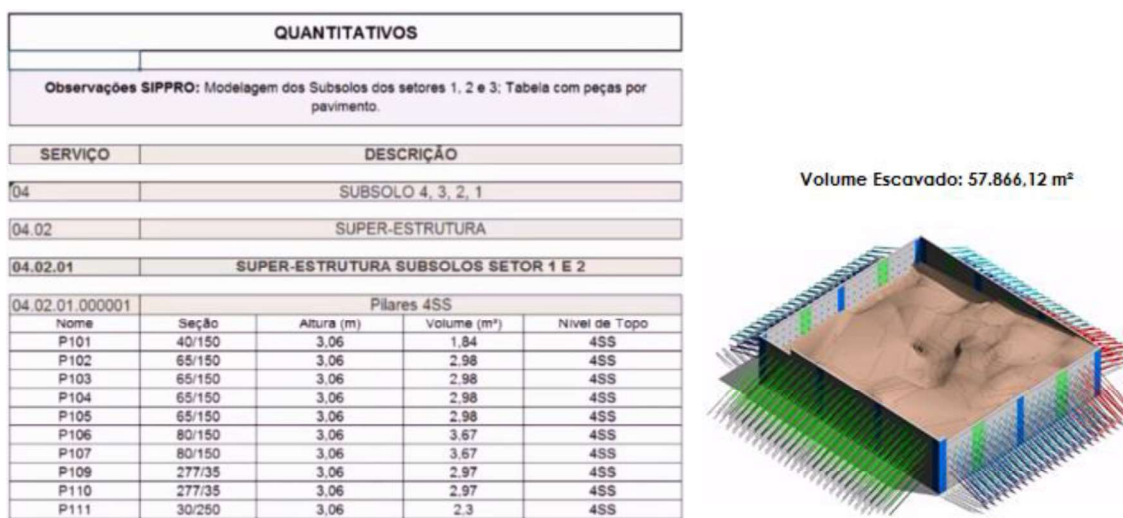
Figura 4 – Estimativa do volume de terra escavado
