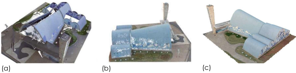
Figura 10 - ISFA: (a) escaneamento a laser; (b) fotogrametria com PIX4D; (c) fotogrametria com ReCap Photo
