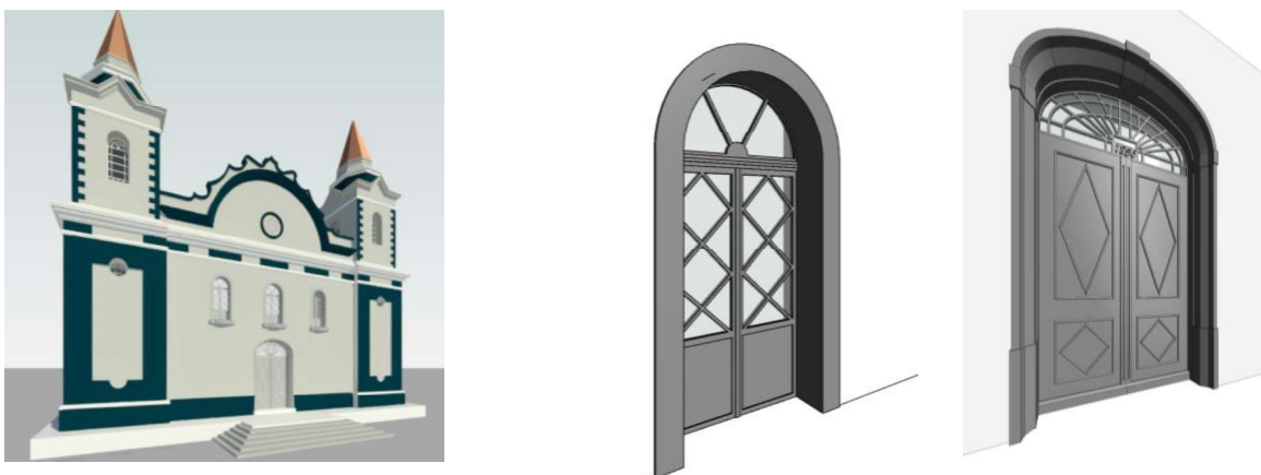
Figura 8 - Fachada (esq.) e famílias de portas da entrada (dir.) e do coro (centro)
