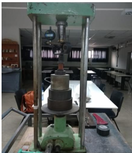
Figura 3: Ensaio de determinação de resistência à compressão axial.
