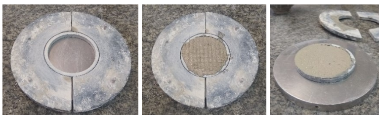
Figura 2: Preparo de amostra para o ensaio squeeze-flow sobre base metálica normatizada
