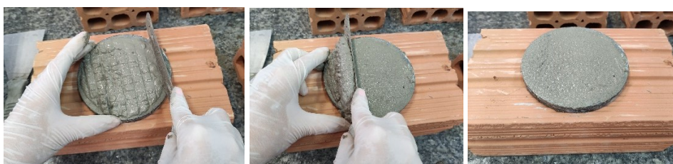
Figura 3: Preparo de amostra para o ensaio squeeze-flow sobre substrato cerâmico
