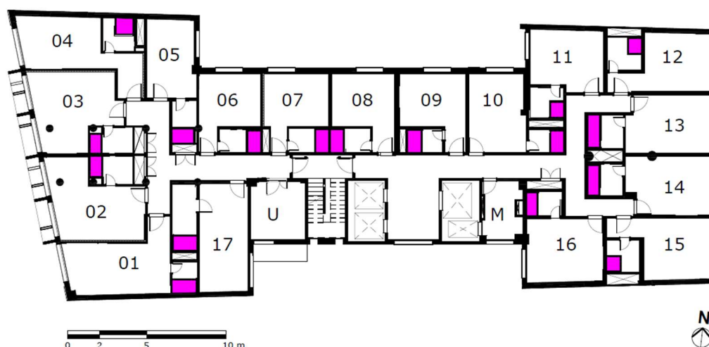
Figura 2 - Mapeamento das áreas impermeabilizadas no pavimento tipo da edificação
