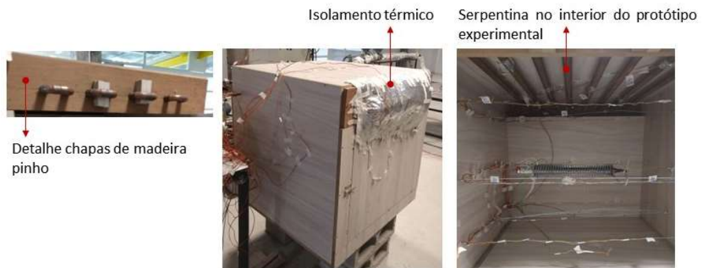
Figura 4: Instalação da Serpentina de resfriamento passivo no protótipo experimental
