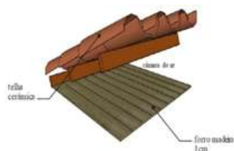
Figura 3: Configuração da cobertura
