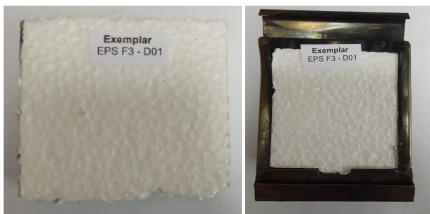
Figura 5: Exemplares utilizados no ensaio de Densidade óptica de Fumaça - ASTM E662
