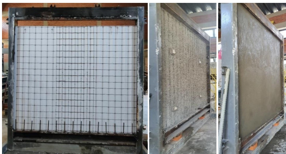
Figura 1: Montagem do sistema, sendo: o núcleo e tela de aço (à esquerda), núcleo com chapisco (ao centro) e o sistema rebocado (à direita)
