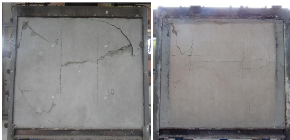
Figura 6: Amostra pós-ensaio, face exposta às altas temperaturas (imagem à esquerda) e não exposta às altas temperaturas (imagem à direita)
