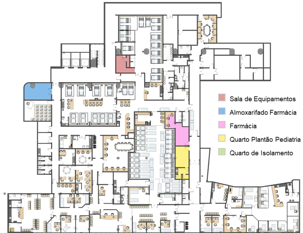
(a) Planta emergência existente antes da reforma
