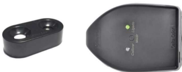
Figura 5: Colorímetro portátil utilizados na pesquisa.
