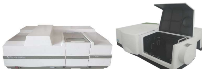
Figura 3: Espectrofotômetros Varian Cary 5G e PerkinElmer Lambda 1050 , respectivamente.
