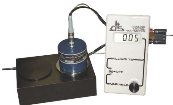
Figura 4: Emissômetro portátil utilizado na pesquisa.
