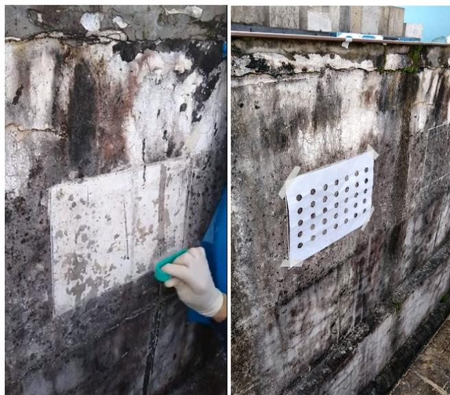
Nota: escovação em movimentos horizontais (à esquerda); molde com 35 pontos posicionados no local de cada medição por espectrofotômetro portátil (à direita).
