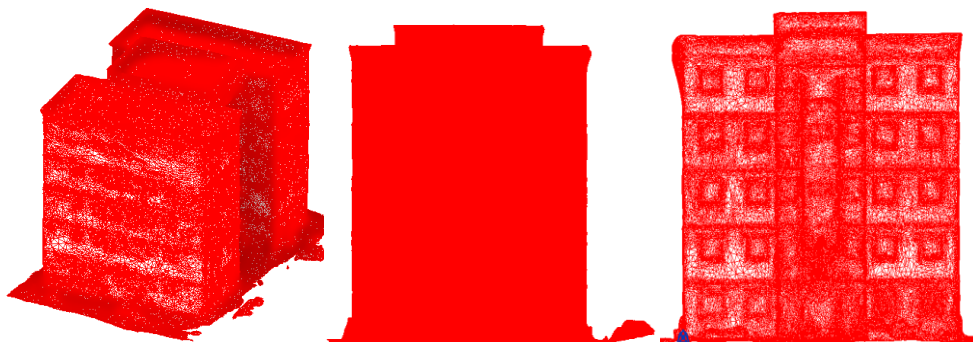
[2][12][13] Figura 8: Nuvem de pontos gerada por fotogrametria e aplicada no software Autodesk Revit: geral (à esquerda), fachada I (ao centro) e fachada II (à direita) da edificação.
