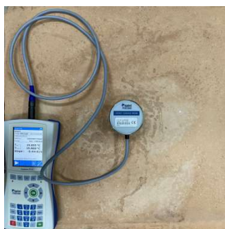
Figura 1: Medição das propriedades térmicas na placa de SCAA com 25% de RCC.
