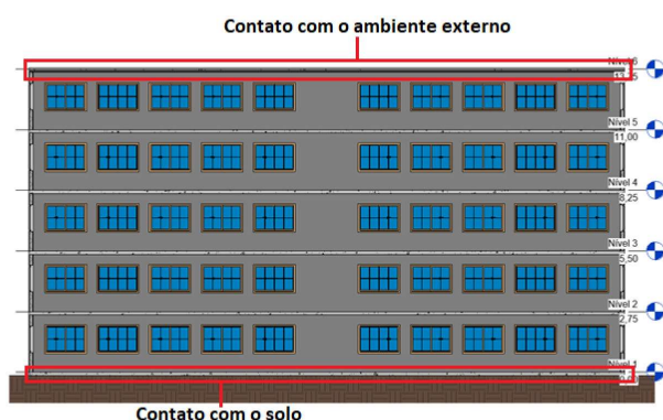
Figura 15: Análise das condições do piso e da cobertura
