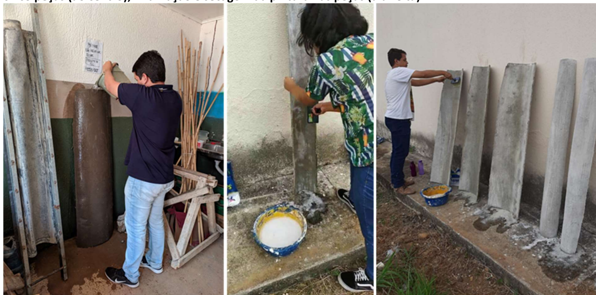
Figura 4 – Molhagem das peças adequada ao processo de cura dos telhões (à esquerda); pintura com cal em cinco peças (ao centro); finalização e secagem da pintura nas peças (à direita)
