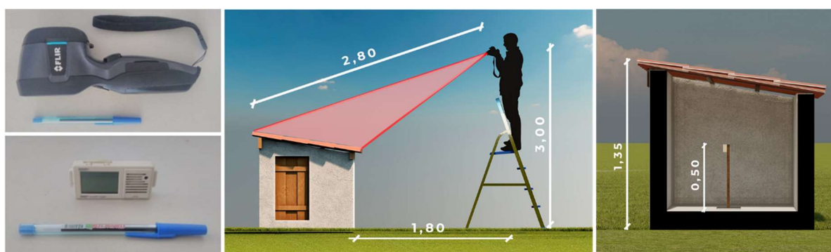
Figura 5 – Câmera termográfica FLIR, modelo i7 (à esquerda acima); datalogger HOB0®, modelo UX100-003 (à esquerda abaixo); posicionamento da câmera termográfica para registro da temperatura superficial das telhas (ao centro) e do datalogger no centro geométrico de cada célula-teste fixados em um suporte de madeira com base metálica para o monitoramento da temperatura do ar interna (à direita)
