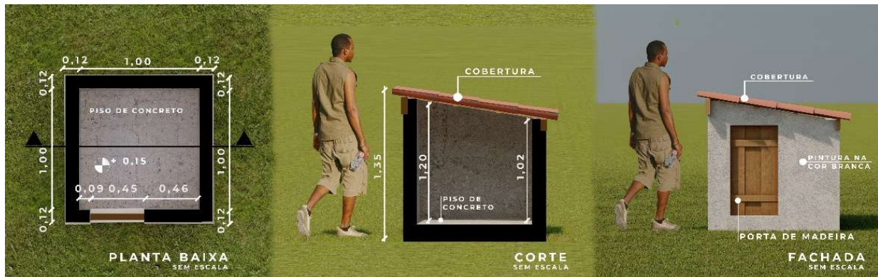
Figura 2: Elementos construtivos e dimensionamento das células-teste
