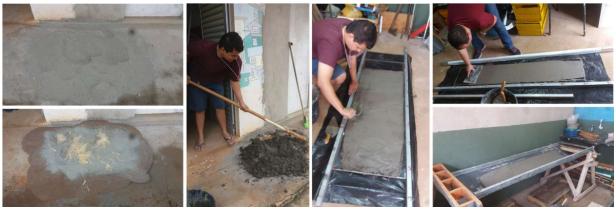
Figura 3 – Confecção e moldagem dos telhões de argamassa a partir de traço de areia e cimento (à esquerda acima); acrescido de fibra vegetal (à esquerda abaixo); misturado com água (à esquerda ao centro); vertido sobre lona esticada sobre chapa de compensado (à direita ao centro e à direita acima); a qual foi posteriormente apoiada sobre dois cavaletes nivelados para processo de secagem e moldagem das peças (à esquerda abaixo).
