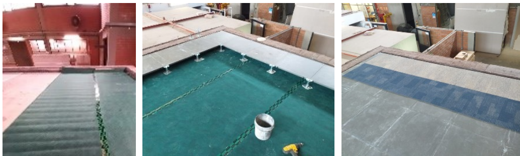
Figura 4: Camadas utilizadas nos testes: manta betuminosa (à esquerda), piso elevado (ao centro) e placas de carpete (à direita)
