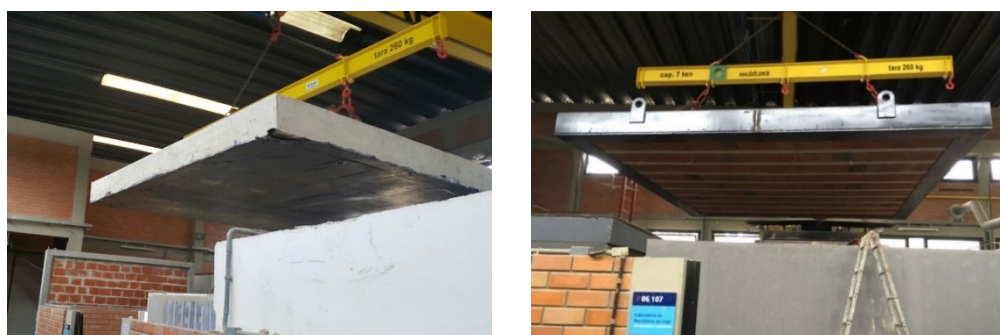
Figura 2: Movimentação das amostras de lajes nervuradas (à esquerda) e das lajes tipo vigota/lajota (à direita)
