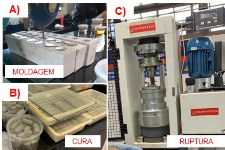
Figura 4: A – Moldagem dos corpos de prova; B- Cura; C- Ruptura dos corpos de prova
