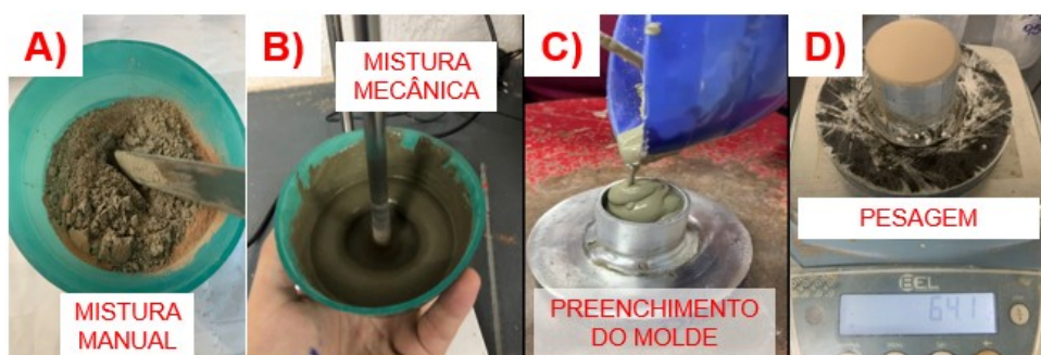
Figura 3: A – Mistura manual; B – Mistura mecânica; C – Inserção no molde; D – Pesagem
