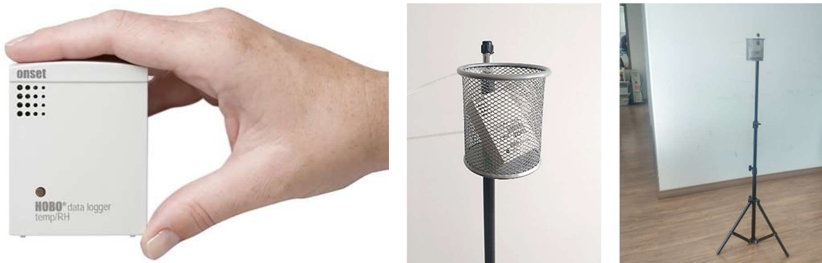
Figura 2: Aparelho utilizado para medir e registrar as temperaturas internas e externas do ar.
