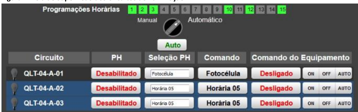
Figura 7: Tela de Supervisão dos Circuitos de Iluminação
