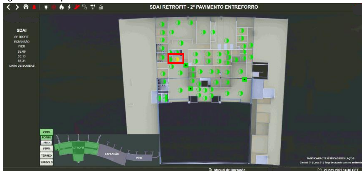
Figura 10: Tela Supervisório de SDAI 2º Pavimento
