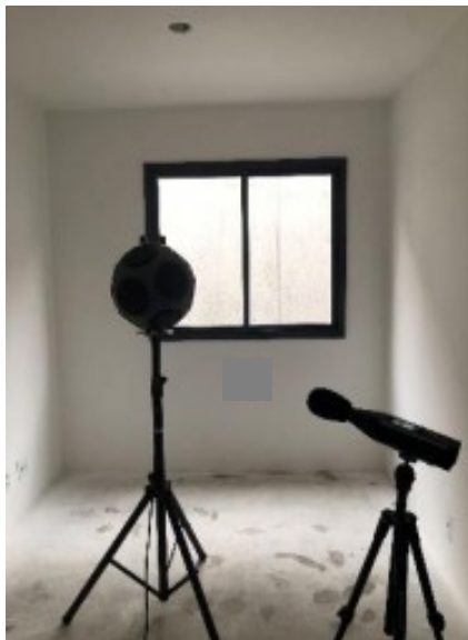
a) Ambiente emissor com a fonte sonora e o sonômetro
