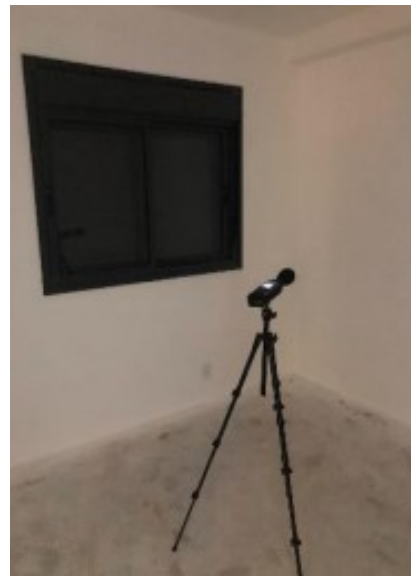
b) Ambiente receptor com o sonômetro em posição de medição
