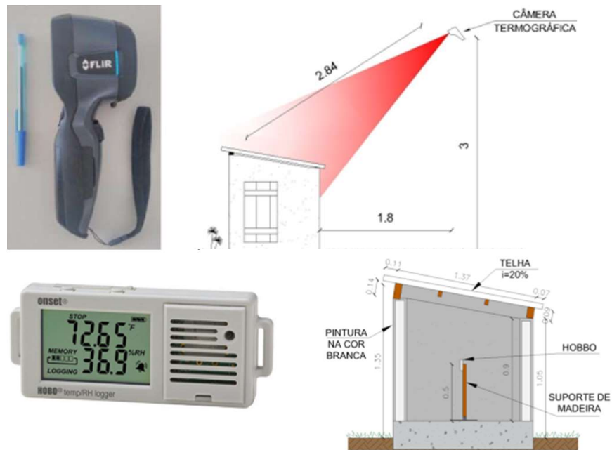
Figura 3: Câmera termográfica FLIR i7 (superior à esquerda); Face externa da cobertura coletada pela câmera termográfica (superior à direita); Hobo® datalogger modelo UX100-003 (inferior à esquerda); e disposição do equipamento no interior da célula-teste (inferior à direita).
