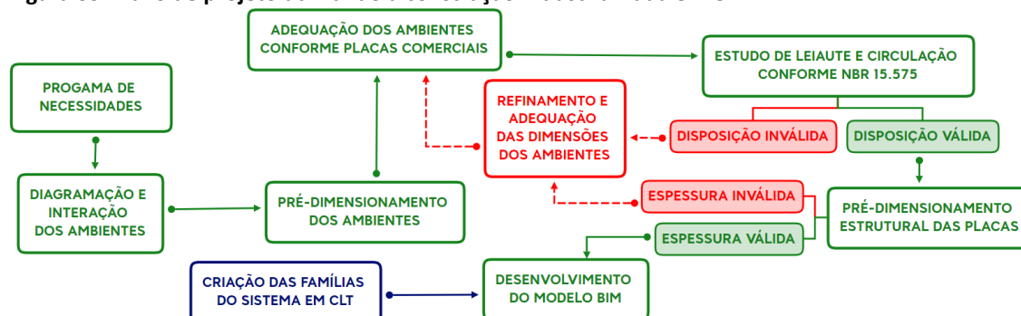
Figura 03: Fluxo de projeto utilizando a construção Industrializada em CLT
