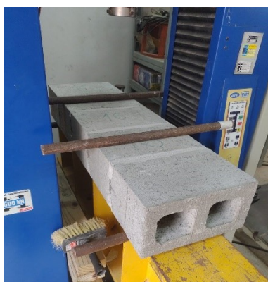
Figura 4: Ensaio de resistência à tração na flexão – NBR 16868-3 (2020)
