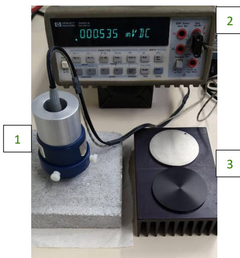
Figura 3: Emissômetro portátil: 1) Detector; 2) Multímetro; 3) Padrões de calibração.
