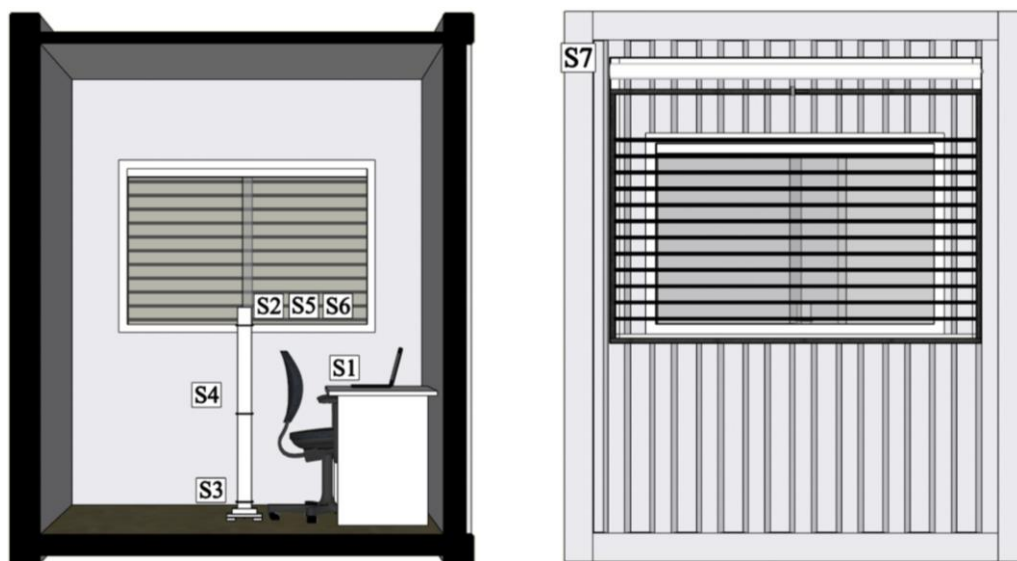
Figura 1 - Distribuição dos sensores no ambiente experimental. Corte (à esquerda) e vista frontal (à direita).
