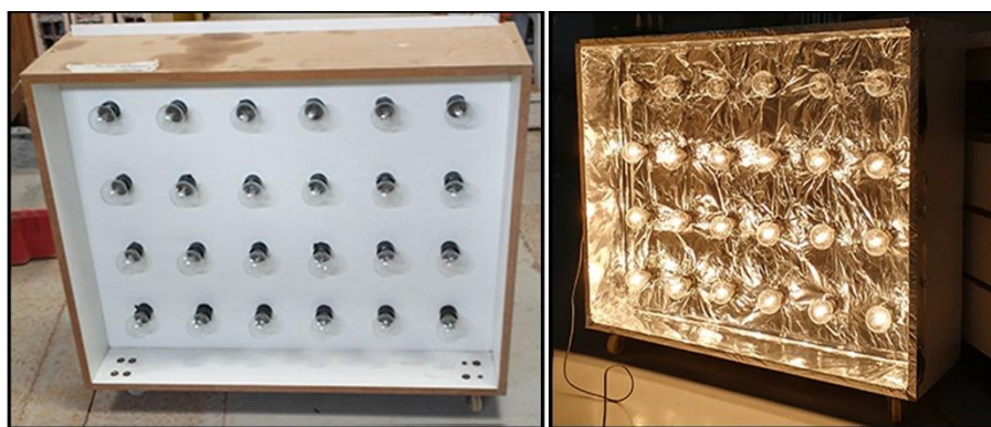
Figura 1: Estrutura do painel radiante (à esquerda) e painel com revestimento reflexivo (à direita)
