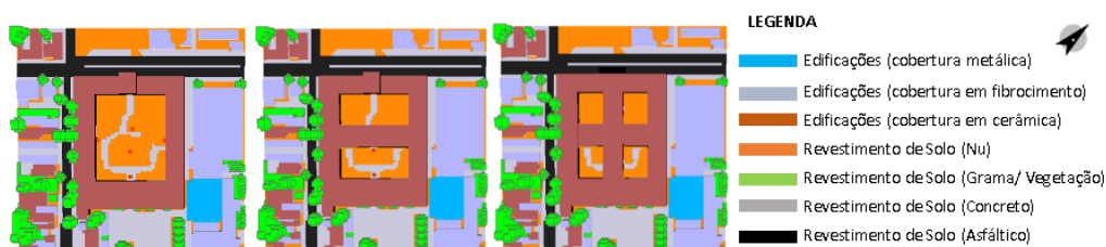
Figura 3: Mapeamento das superfícies da região da pesquisa e arranjos espaciais hipotéticos do pátio: pátio original (à esquerda); fragmentado em dois (ao centro); fragmentado em quatro (à direita)
