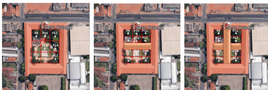
Figura 4: Receptores do modelo computacional para calibração e avaliação da influência da variação do arranjo espacial do pátio: pátio sem fragmentação (à esquerda); fragmentado em dois (ao centro); fragmentado em quatro (à direita)
