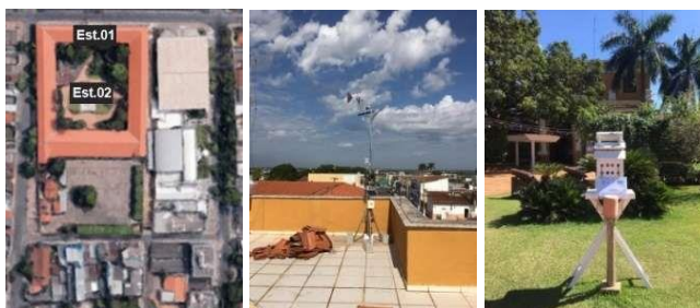
Figura 2: Indicação do posicionamento das estações (à esquerda), Est.01 - instalada no nível do telhado (ao centro); Est.01 – instalada no nível do solo no interior do pátio (à direita)
