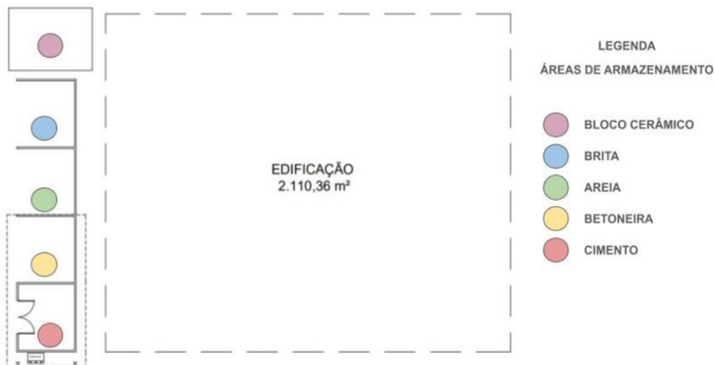
Figura 8: Áreas de armazenamento de agregados, cimentos e blocos cerâmicos.
