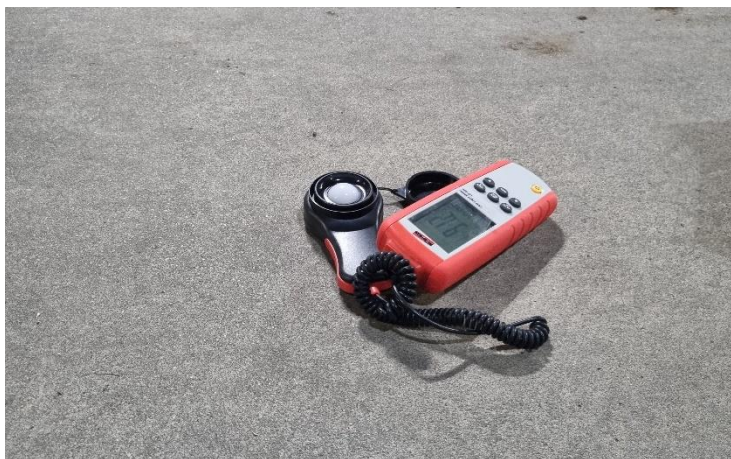
Figura 3: Luxímetro digital utilizado nas medições posicionado sobre superfície horizontal
