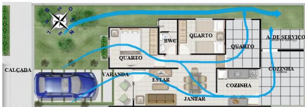
Figura 5 - Escoamento da ventilação orientação Sudeste com reforma
