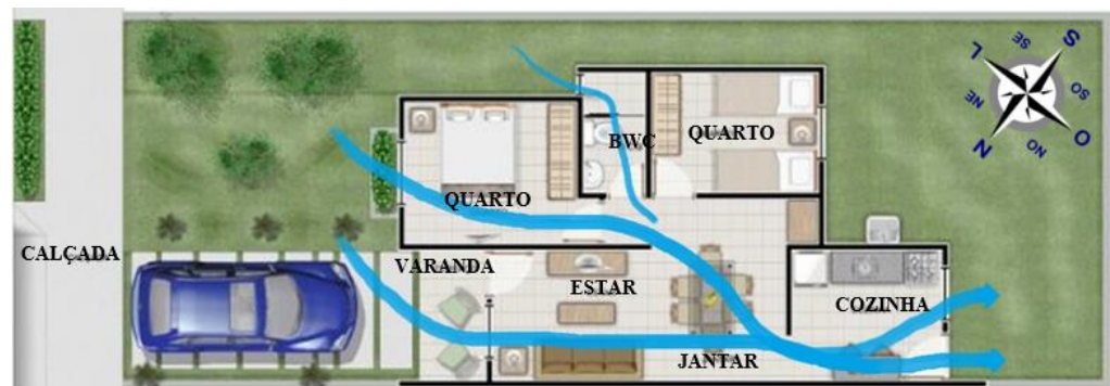
Figura 12 - Escoamento da ventilação nas unidades originais implantadas com orientação Nordeste
