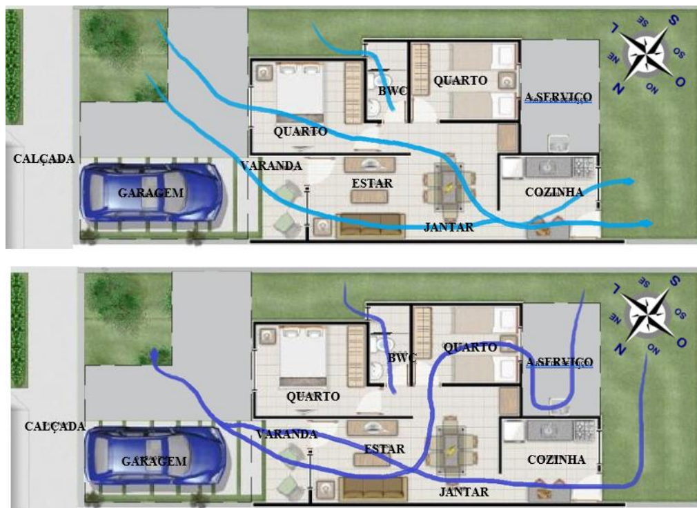
Figura 13 - escoamento da ventilação orientação Nordeste com reforma
