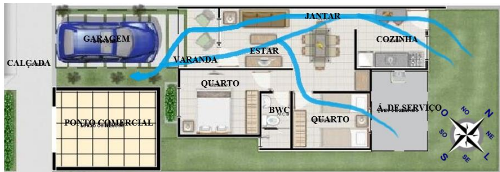
Figura 9 - Escoamento da ventilação Orientação Sudoeste com reforma
