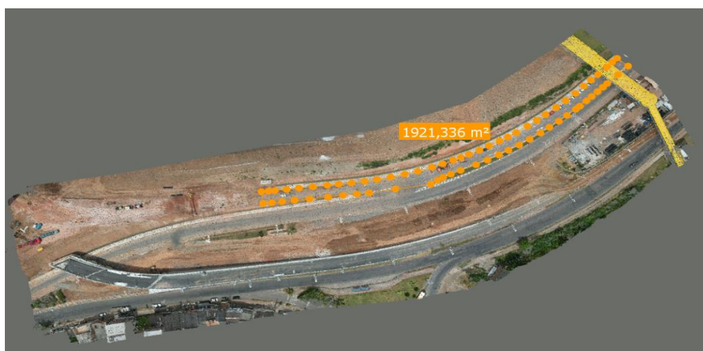
Figura 7: Extração quantitativa da área da camada de asfalto (CBUQ) a partir da nuvem de pontos
