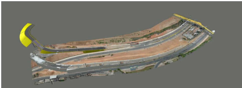
Figura 4: Sobreposição entre a nuvem de pontos e o modelo 3D
