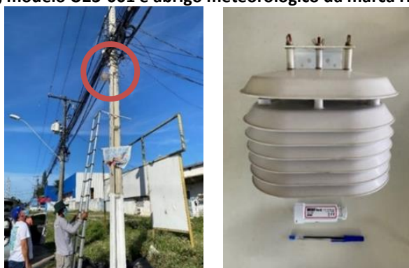
Figura 6 - (à esquerda) Foto da instalação do Hobo (à direita) datalogger de temperatura do ar, marca Hobo, modelo U23-001 e abrigo meteorológico da marca Hobo, modelo RS1
