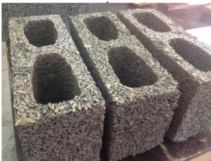
Figura 4: Bloco vazado de concreto com agregado de resíduos de madeira Pinus spp.
