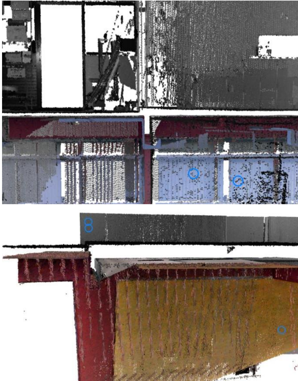
Figura 6 – Detalhes das diferenças de nível nos andares e entre os elementos construídos. (à acima - Diferença de nível interna da edificação) (à abaixo - Espessura das lajes maciças e vigas)
