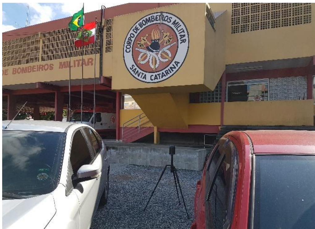
Figura 4 – Imagem do equipamento da Leica, o laser scanner BLK360, entre os dois carros
