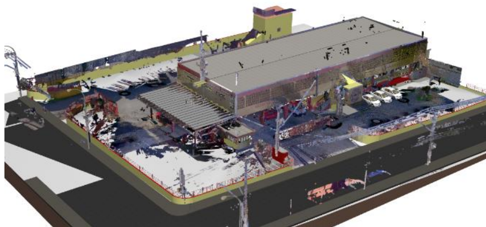
Figura 9 – Modelo ajustado com a nuvem de pontos sobreposto à nuvem de pontos
