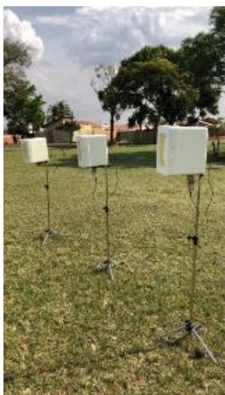
Para as medições, os termômetros foram inseridos, ao longo de quatro dias do mês de setembro de 2023, ao redor da árvore, sendo feitas três medições diurnas, entre 10:00 horas e 13:00 horas e entre 13:00 horas e 16:00 horas, nas quatro faces da copa da árvore, norte, sul, leste e oeste. Foram utilizados 4 termômetros simultaneamente, onde o termômetro 01 ficou debaixo da árvore, e os termômetros 02, 03 e 04 ficaram a 30cm, 1m e 2m respectivamente, conforme demonstrado na figura 5.
